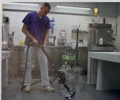
Der überhitzte Trockendampf entfernt Rückstände, Keime und Viren von allen Oberflächen. Auch der Boden benötigt nur Wasser für hygienische Sauberkeit.
